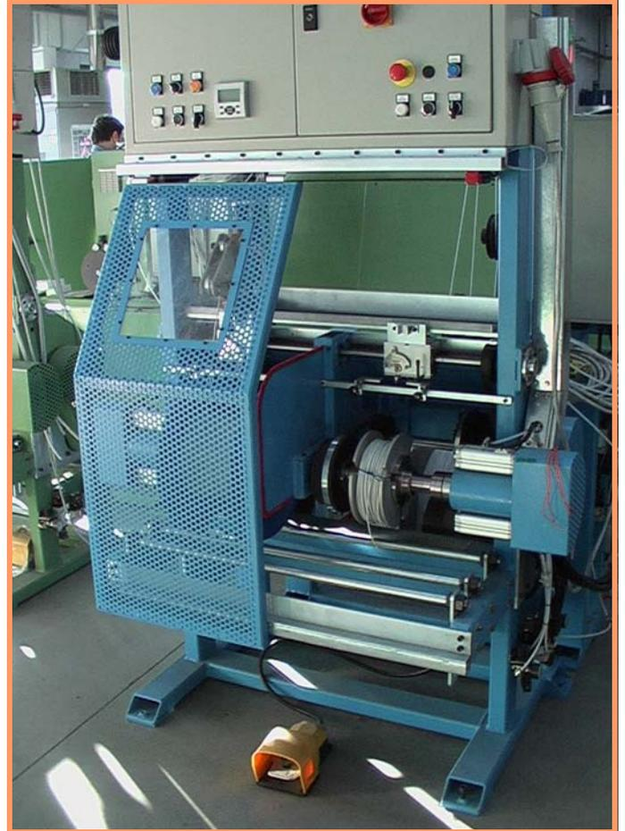
Der Aufwickler Type "AV 2X400 CA 300" ermöglicht die Verpackung von Spulen oder Ringe mit Abmessungen bis max.  $\varnothing$  400 X 200 fuer die Spulen und  $\varnothing$  400 X 90 fuer die Ringe. Der Aufwickler arbeitet abwechselnd mit zwei Koepfen, der eine beim Aufwickeln der andere bei der Verpackung und nuetzt somit die improduktiven Zeit aus: waehrend ein Haspel aufwickelt, kann der Bediennann den zweiten Haspel verpacken und umgekehrt.
